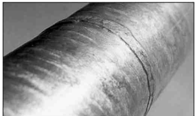
Fotos viser overfladerne på 2 prøver efter varmforzinkning. På den ene prøve er der ingen overtykkelse af zink på svejsesømmen, på den anden prøve er overtykkelsen tydelig. Herunder ses nærbilleder af svejsesømmene.
