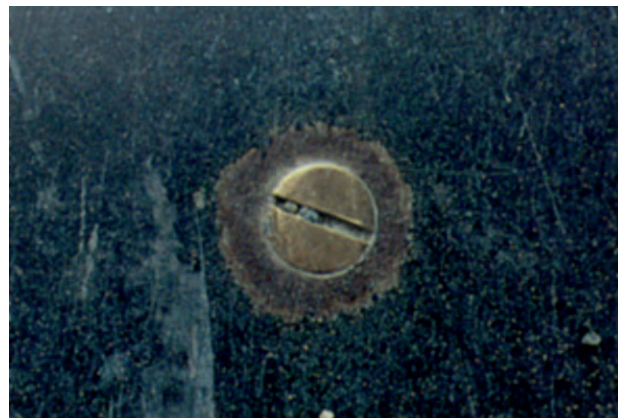
Bild 10-13. Mässingskrav i varmförzinkat stål ger angrepp på zinken.
