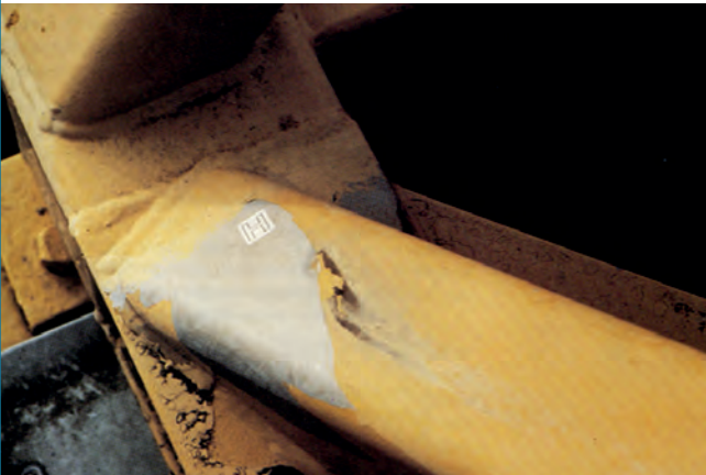
Bild 11-3. Kontrollera alltid med färgtillverkaren att grund- och täckfärg matchar varandra. I detta fall har flagning skett mellan den gula, höggglansiga alkydfärgen och den grå, gummibaserade grundfärgen (22).
