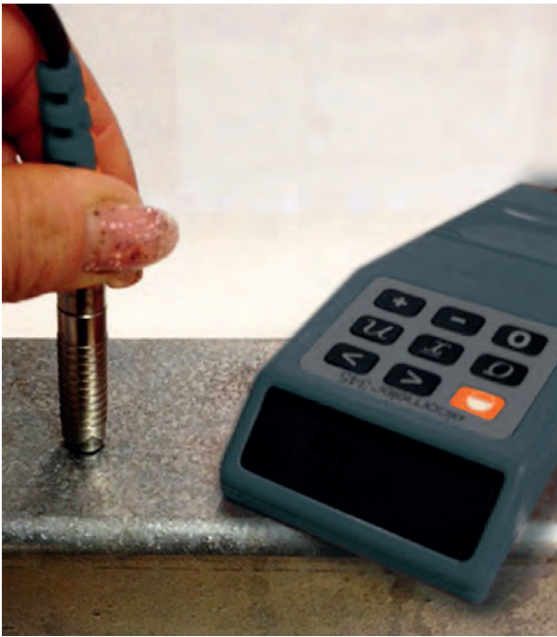
Bild 9-1. Mätning av skiktthjocklek.
