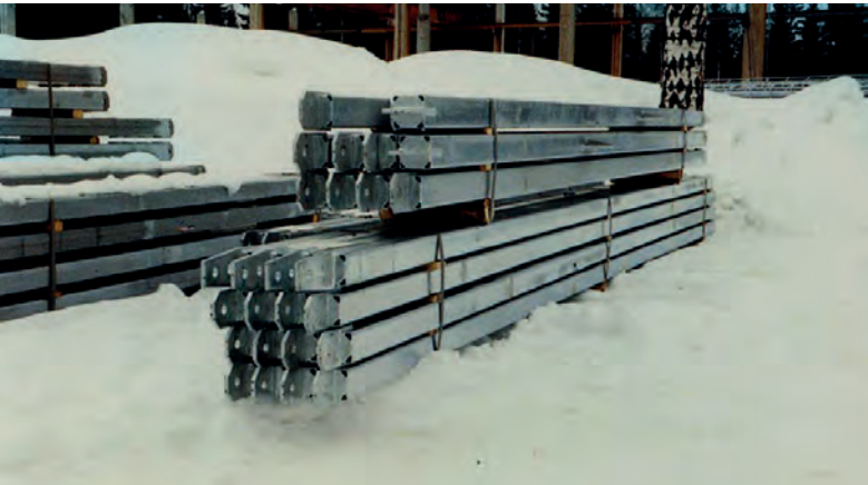
Bild 10-16. Varmförzinkat gods klart för leverans till kund.
