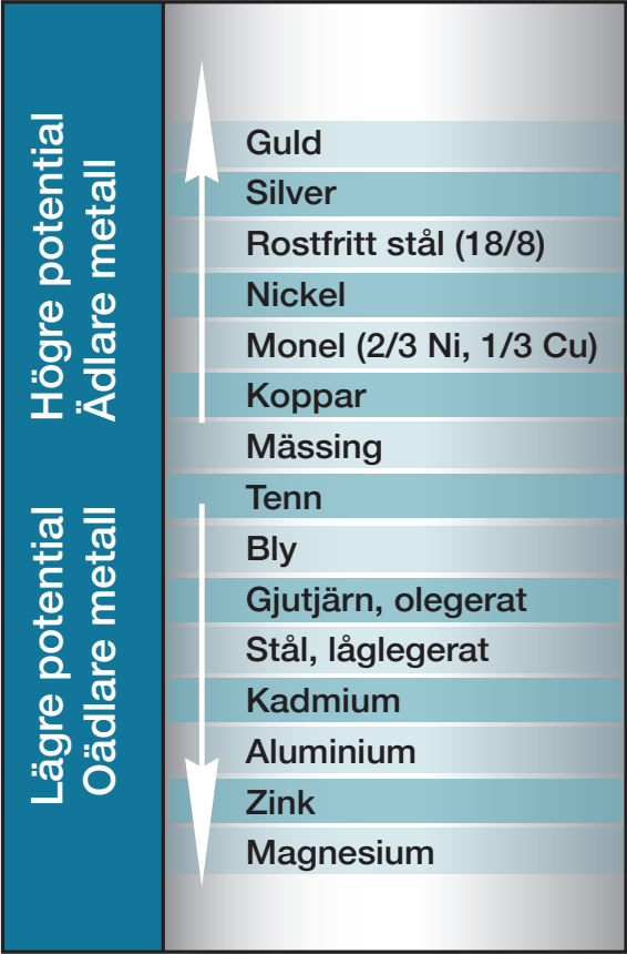
Bild 10-10. Galvaniska spänningsserien i havsvatten vid 25 °C.
