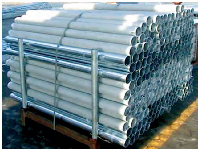
Bild 5-7. Varmförzinkade rör med olika kiselhalt. Vissa rör är tillverkade av aluminiumtätat stål och har fått ett blankt, glänsande skikt, medan andra är tillverkade av kiseltätat stål vilket ger en mattare, grå yta.
