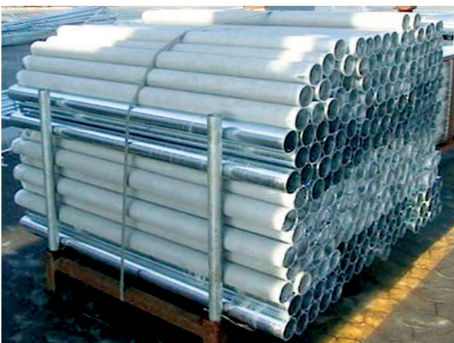
Billede 5-7. Varmforzinkede rør med forskelligt indhold af silicium. Enkelte rør har et indhold af silicium som gør dem egnede til varmforzinkning. Andre rør har et indhold af silicium som ligger i Sandelinområdet (0,03-0,14%) som gør dem uegnede til varmforzinkning, med et mat gråt udseende, og dårlig vedhæftning til følge.
