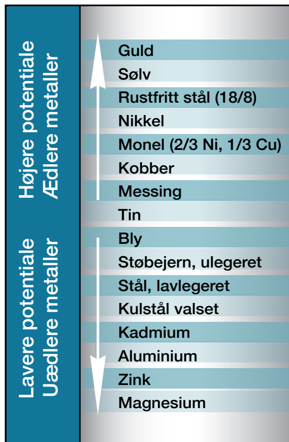
Billede 10-10. Galvanisk spændingsrække i havvand ved + 25 °C.
