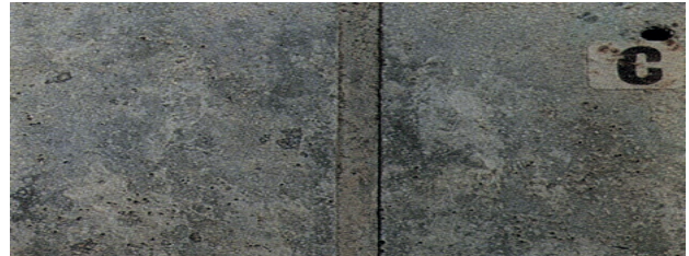
Billede 10-11. Et 6 mm bredt fræset spor gennem en 60 µm tyk zinkbelægning på stål og eksponeret i 5 år i svært industrimiljø i Holland. Bemærk, belægningen af zinksalte i sporet og uden nogen tegn på rustgennemslag.
