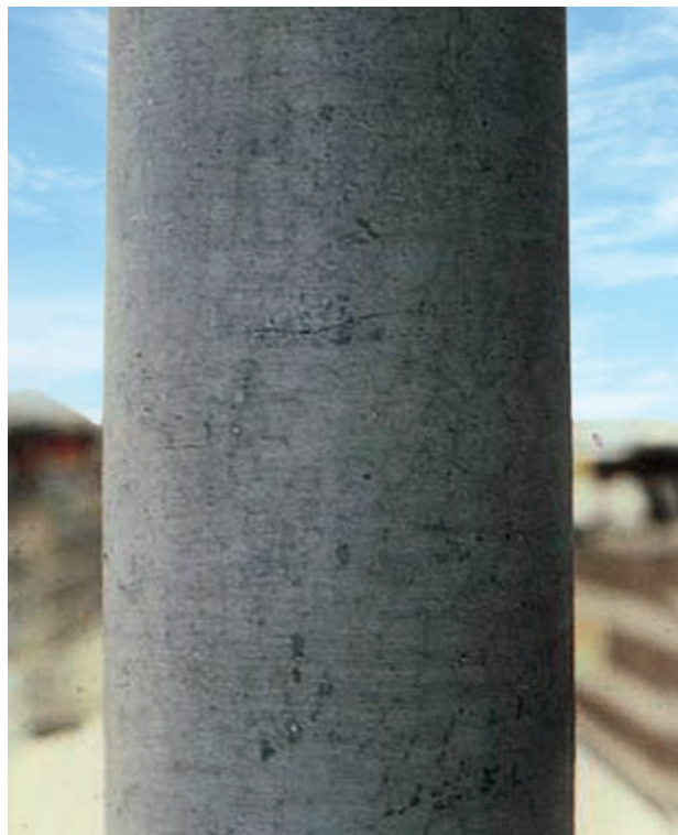
Billede 10-1. Eksponeret overflade af en zinkbelægning med et ydre lag af ren zink. Den blanke overflade er erstattet af et gråt korrosionsprodukt, sommetider kaldet zinkpatina.
