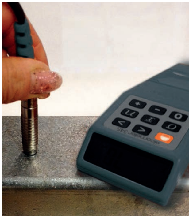
Billede 9-1. Måling af lagtykkelse.
