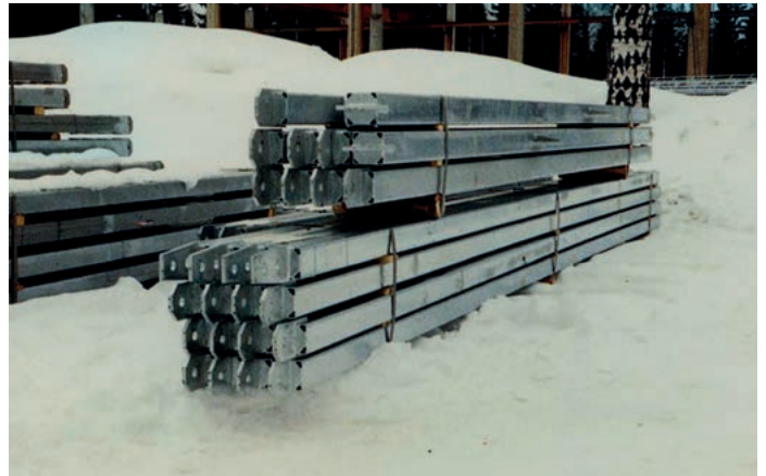
Billede 10-16. Leveringsklart varmforzinket materiale.
