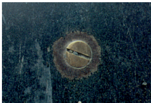
Billede 10-13. Messingskrue i varmforzinket plade angriber zinken.
