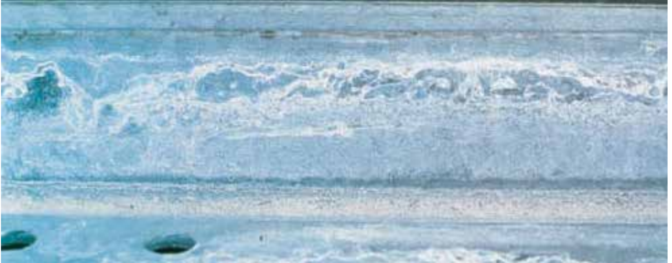
Kuva 1. Valkoruostetta tiiviisti varastoiduissa kulmarauodoissa ulkosäilytyksen jälkeen.
