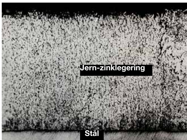
Billede 5-3. Tværsnit af zinkbelægningen på Sandelinstål med 0,06% Si. Forzinkningen udført ved 460 °C
