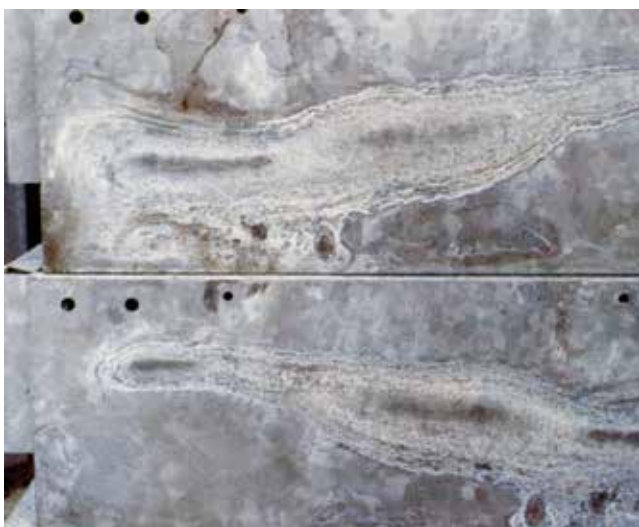
Billede 10-4. Hvidrust dannet mellem sammenlagte materialer.
