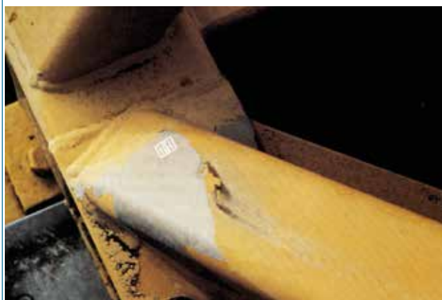
Billede 11-3. Maling skaller af pga. fejlagtig behandling før maling (22).
