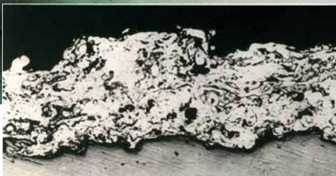
Billede 3-3. Tværsnit gennem sprøjteforzinket belægning
