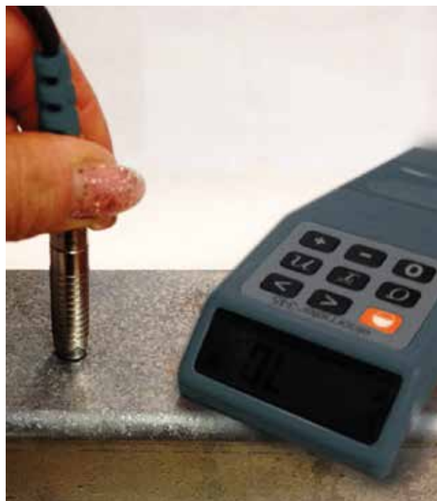
Billede 9-1. Måling af lagtykkelse.
