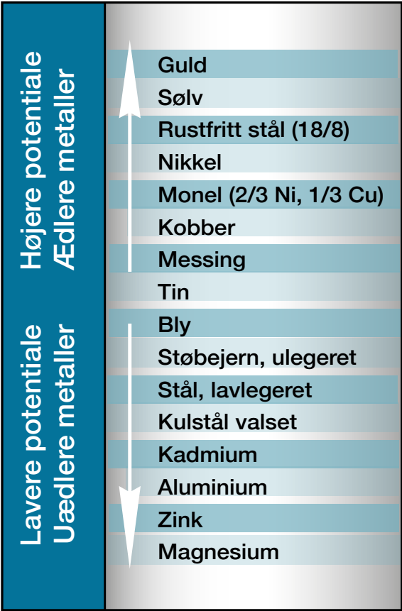
Billede 10-10. Galvanisk spændingsrække i havvand ved + 25 °C.
