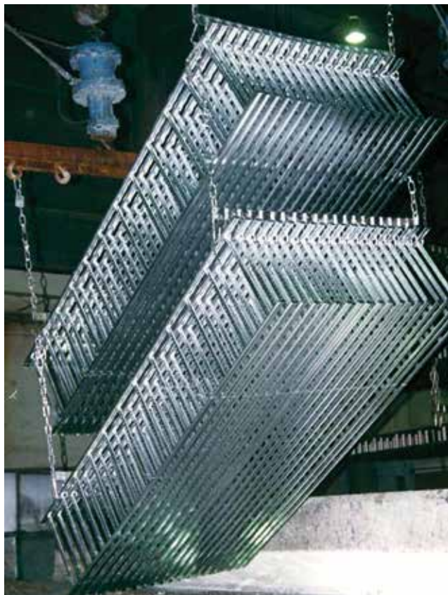
Billede 7-1. Varmforzinkning af kabelstiger, som løftes skråt, for at få et godt afløb af zinken.
