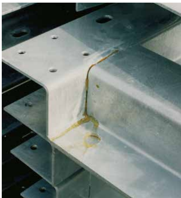
Billede 7-11. Syrelommer, hvor syren og jernsaltene har ætset hul på zinklaget med misfarvninger til følge.
