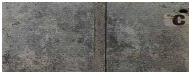
Billede 10-11. Et 6 mm bredt fræset spor gennem en 60 µm tyk zinkbelægning på stål og eksponeret i 5 år i svært industrimiljø i Holland. Bemærk, belægningen af zinksalte i sporet og uden nogen tegn på rustgennemslag.
