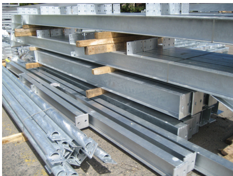
Kuva 44. Välipuut estää tuotteen pintoja hankaamasta toisistaan vasten ja varmistaa hyvän ilmanvaihdon, mikä ehkäisee valkoruosteen muodostumista, kts. kappale 12.
