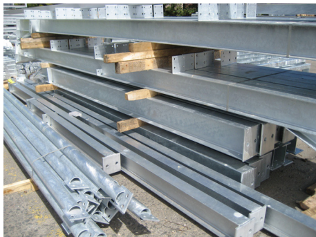
Bild 44. Mellanlägg hindrar godsytorna från att skava mot varandra och ger god luftväxling, vilket motverkar bildandet av vitrost, se avsnitt 12.
