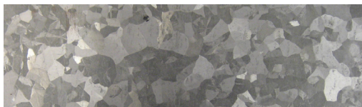
Billede 6. I visse tilfælde ses et blomsterlignende mønster på godset, hvilket skyldes legerings-tilsætninger i zinkbadet.
