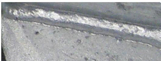
Billede 25. Udseendet på en sammenhængende svejsesøm efter varmforzinkning.
