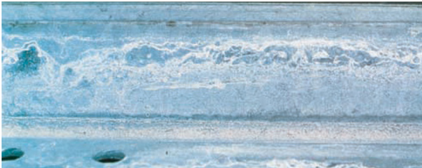
Figur 1. Hvidrust dannet på tæt sammenlagte vinkeljern efter udendørs oplagring.
