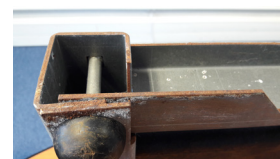
Figur 2. ZM-stål med ubelagte skærekanter, hvor den selvhelende effekt ikke har kunnet beskytte overfladerne.
