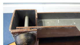
Kuva 2. ZM-teräs, jossa on pinnoittamattomat leikkausreunat ja jossa itsestään korjautuva vaikutus ei ole pystynyt suojaamaan pintoja.
